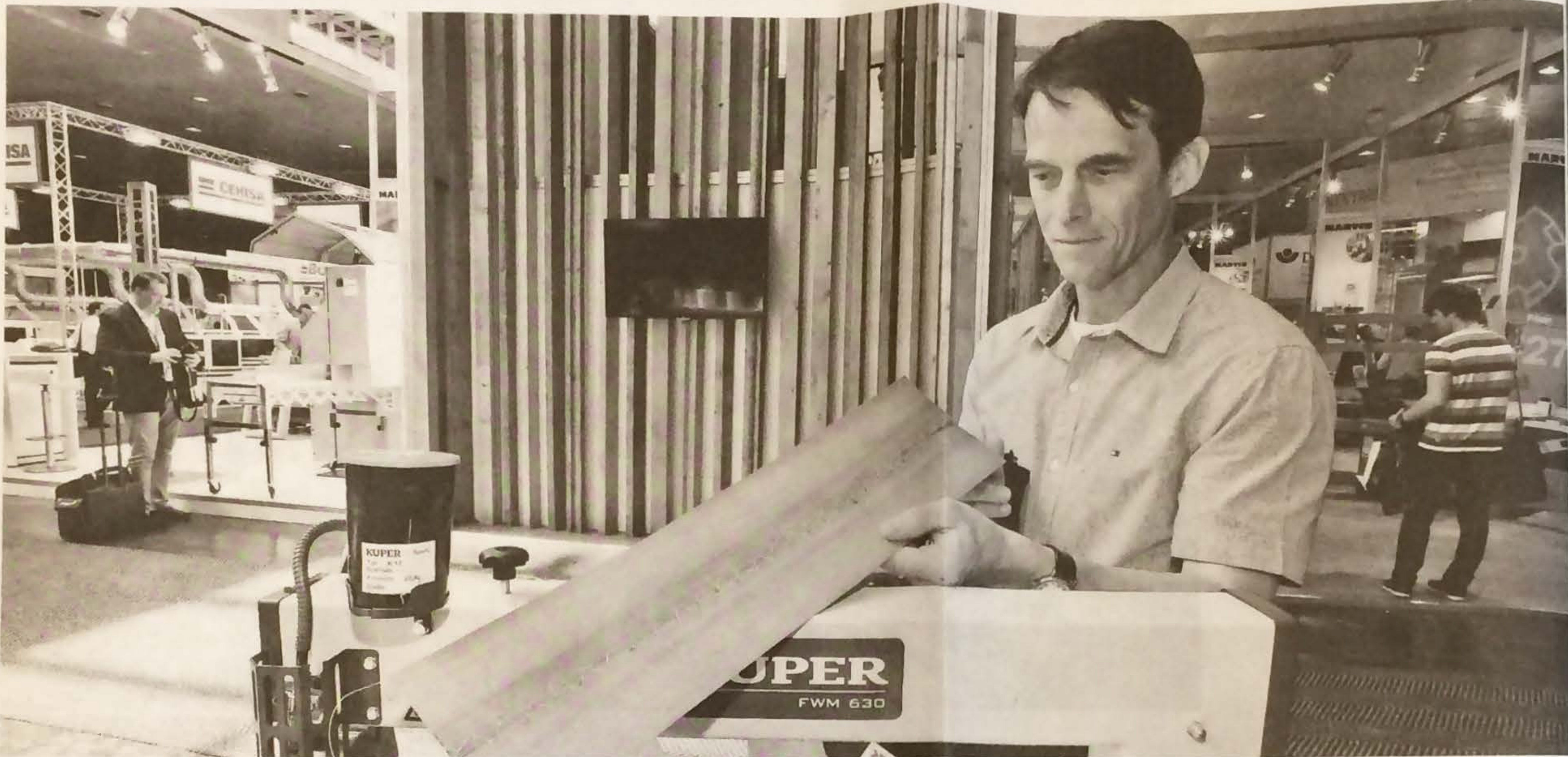
Präzisionswerkzeug: Tischler Ralf Klebe sieht auf der Ligna die Furniermaschine „Kuper FWM 630“, die bei ihm im Betrieb steht. Wie eine Nähmaschine verklebt sie feine Furnierstücke mit einem Garn.
